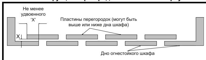
Рис. 3-2 Конструкция перегородок огнестойкого корпуса
