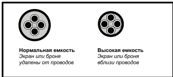
Рис. 4-13 Конструкция кабеля влияет на его емкость
